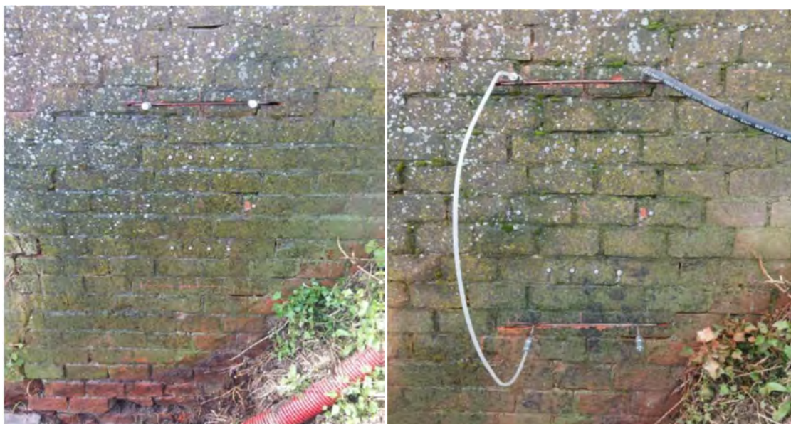
Figura 7: Immagini della prova con martinetto piatto – 2015
